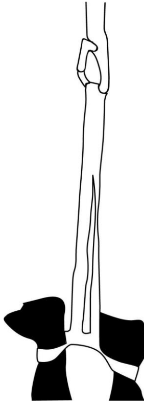
Figura 13. Cinghia di salvataggio di classe C. È progettata in modo che la persona da salvata sia mantenuta a testa in giù, con le cinghie intorno alle caviglie durante l'azione di soccorso. Se possibile, le braccia e la testa devono essere protette.
