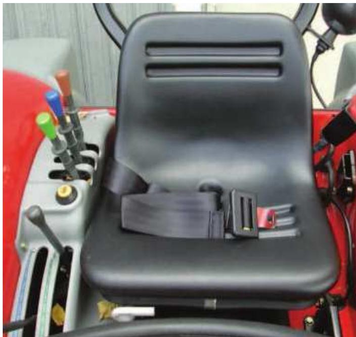
Oltre alla struttura di protezione del posto di guida, tutte le trattrici devono avere un dispositivo di ritenzione (cintura di sicurezza) che, in caso di capovolgimento del mezzo, trattiene il conducente al sedile, cioè all'interno di un volume di sicurezza.
