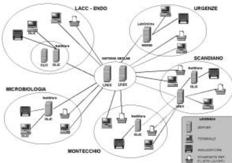
complessità del L.I.S. è accentuata dal fatto di essere composto da più applicativi operanti su diverse piattaforme software. Il sistema principale (NETLAB) è affiancato da due sottosistemi destinati all'interfaccia con gli analizzatori (Figura 1).
